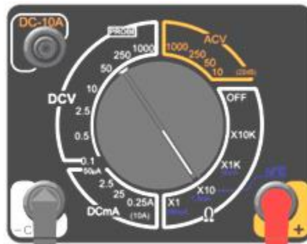
Gambar 3.15 Selektor range Ohmmeter
