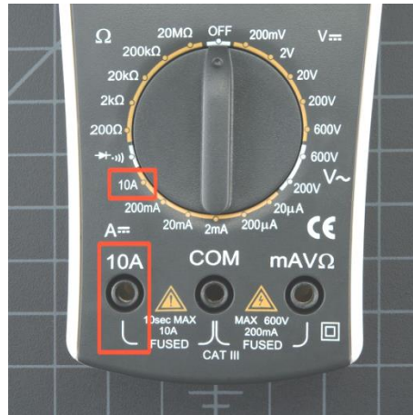
Gambar 3.23 Port 10A pada digital multimeter
