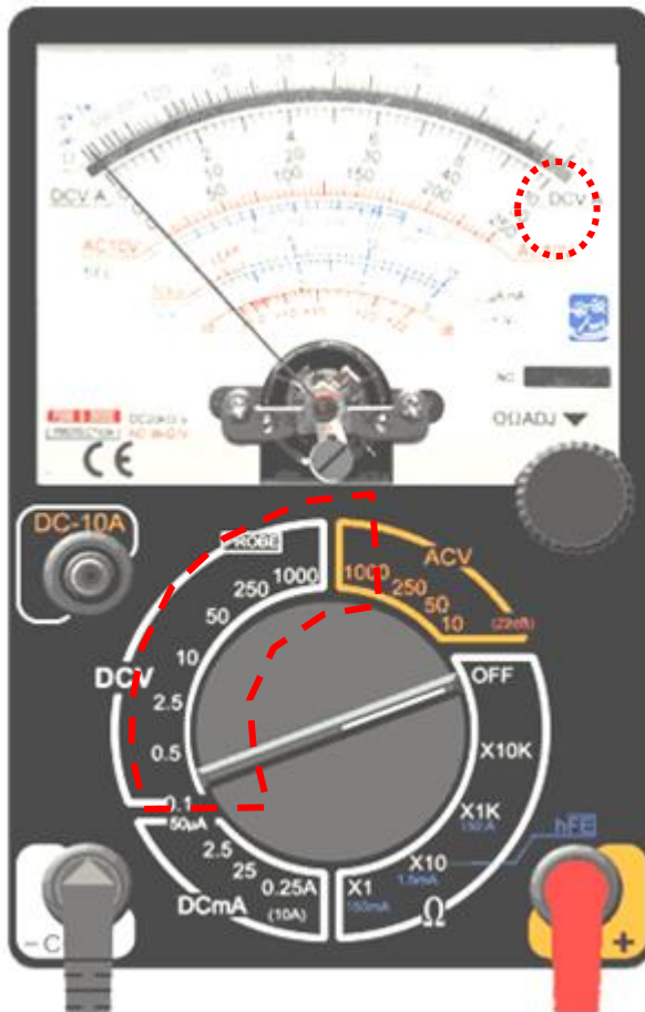
Gambar 3.11 Skala pembacaan dan selektor pada multimeter analog untuk mengukur tegangan DC
