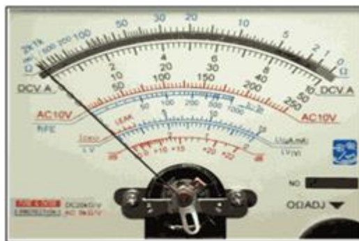
Gambar 3.13 Posisi pointer sebelum probe ditempelkan
