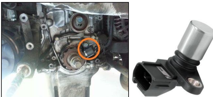
Gambar 6.34 Contoh crank sensor dan penempatannya
