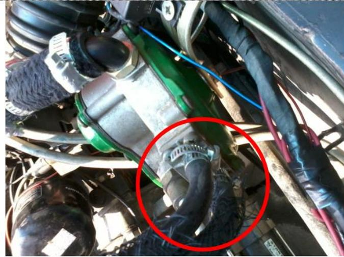
**Gambar 4.2 Vaporizer dengan selang air (water house) berukuran kecil**
