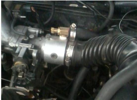
**Gambar 4.17 Pemasangan mixer dan katup akselerasi**
