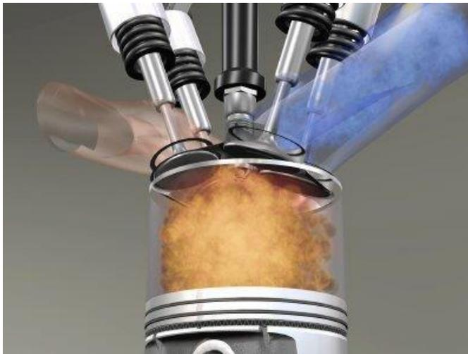
**Gambar 1.4 Penyebaran api pada mesin SI (*premixed flame*)**
