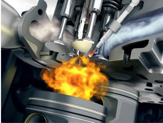
**Gambar 1.7 Penyebaran api pada mesin CI (*diffusion flame*)**
