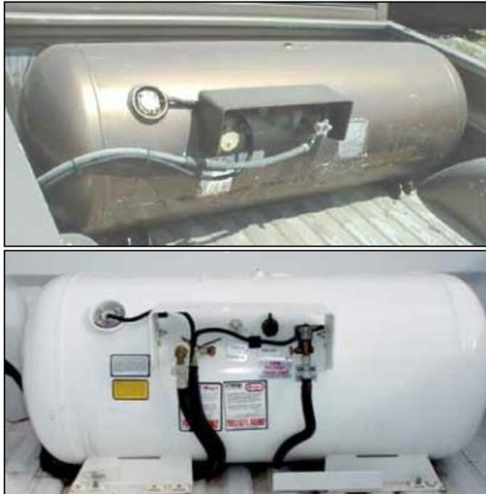
**Gambar 4.9** Pemasangan tangki pada jenis *pick up*
