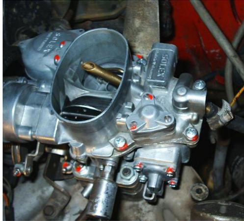
**Gambar 4.3 Karburator solex dengan bentuk *air horn* oval**
