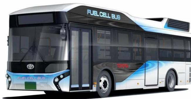
**Gambar 1.11 Prototipe bus dengan propulsi *fuel cell***
