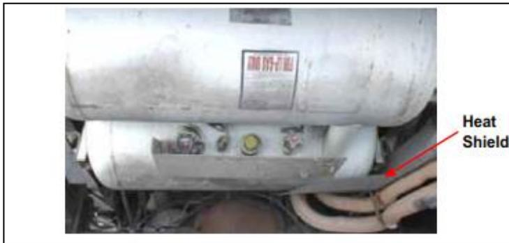
**Gambar 4.10 Pemasangan pelindung panas**
