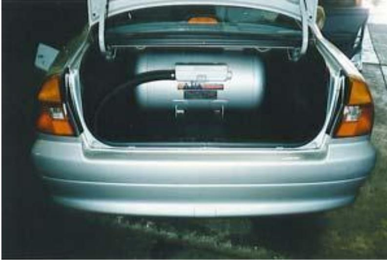
**Gambar 3.5 Berkurangnya ruang bagasi untuk peletakan tabung LPG**
