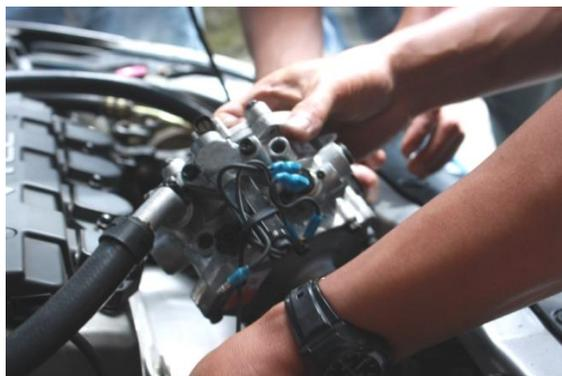
**Gambar 4.16** Pemasangan vaporizer pada ruang mesin
