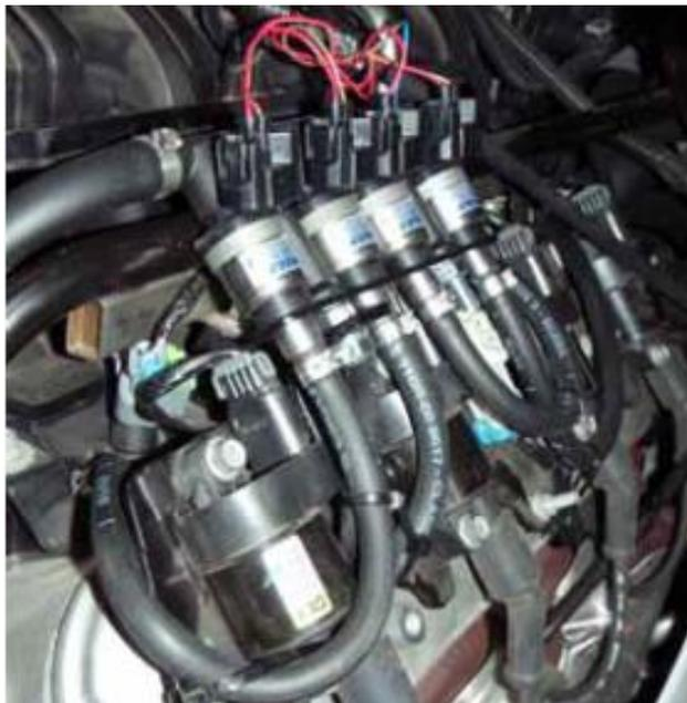
**Gambar 4.19** Injektor LPG dan saluran ke *manifold*
